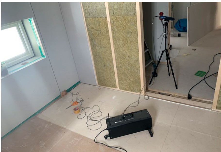
Pågående mätning av ljudisolering med en stegljudsmaskin.
