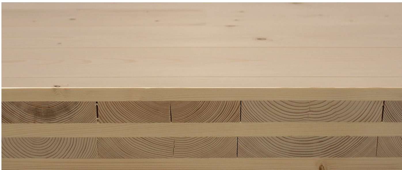
Figur 4: Typiskt KL-element med fem korslagda lager. Dessa finns i många olika kombinationer men alltid minst tre korslagda lager.
